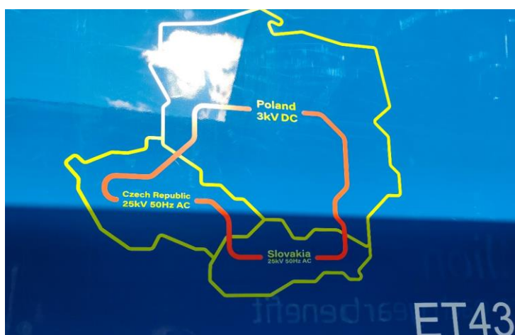
Połączenie kolejowe pomiędzy Krajami Polska – Czechy – Słowacja - Polska bez zmiany lokomotywy mimo dwóch różnych napięć w sieci trakcyjnej. Lokomotywa – elektrowóz dwusystemowy.
