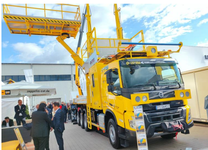
Pojazd firmy Compa do budowy i eksploatacji napowietrznej sieci trakcyjnej kolejowej i tramwajowej. Pojazd został zakupiony na targach przez firmę ZRK DOM z Poznania
