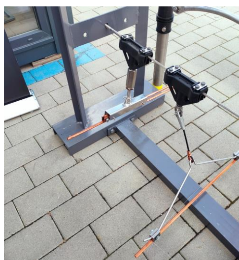
Podwieszenie napowietrznej tramwajowej sieci trakcyjnej z możliwością przesuwania.
